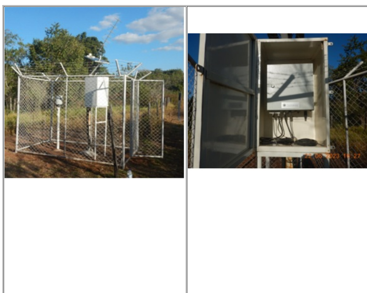
Figuras 04 e 05. Exemplo de shieldde proteção metálico em aço galvanizado com cadeados.
