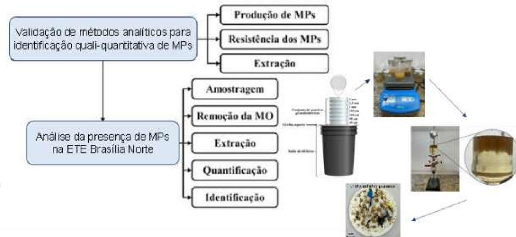
Figura 1: Fluxograma simplificado para avaliar metodologias de quantificação de microplásticos (MPs) no esgoto e aplicar a metodologia para avaliação da remoção de microplásticos em ETEs.
