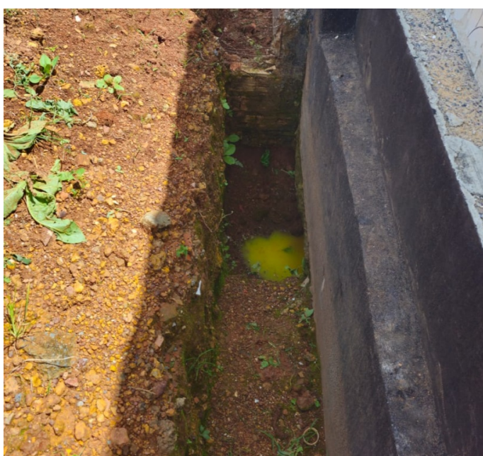
Fotos 6-9: teste realizado com a presença de corante no sistema de esgoto do lote 27
