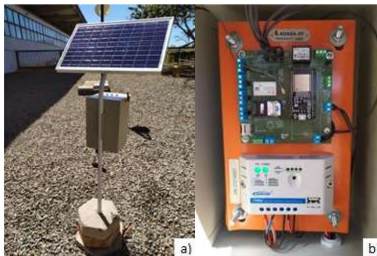
Figura 22 – a) Painel solar acoplado ao datalogger telemétrico que compõe as estações pluviométricas da Adasa; b) Interior da caixa que reveste o datalogger, placa controladora e placa principal
