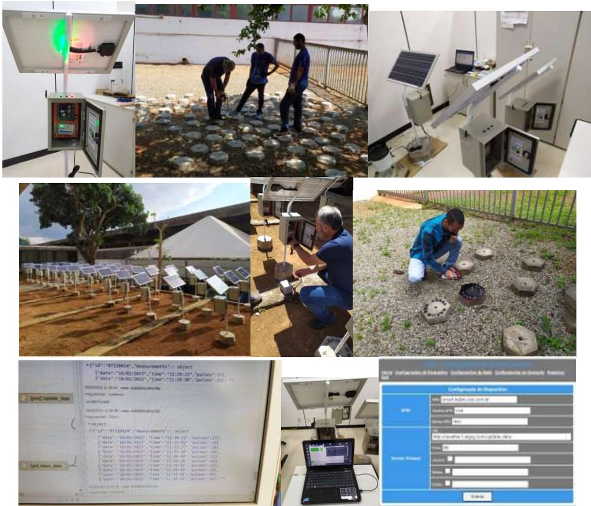
Figura 24 – Mosaico com imagens das diversas etapas concluídas – preparação, ajustes e testes dos dataloggers telemétricos e de transmissão de dados
